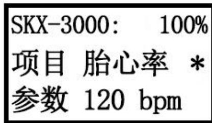
本模拟仪使用 OLED 屏幕显示内容，软件界面共有 3 行显示内容
