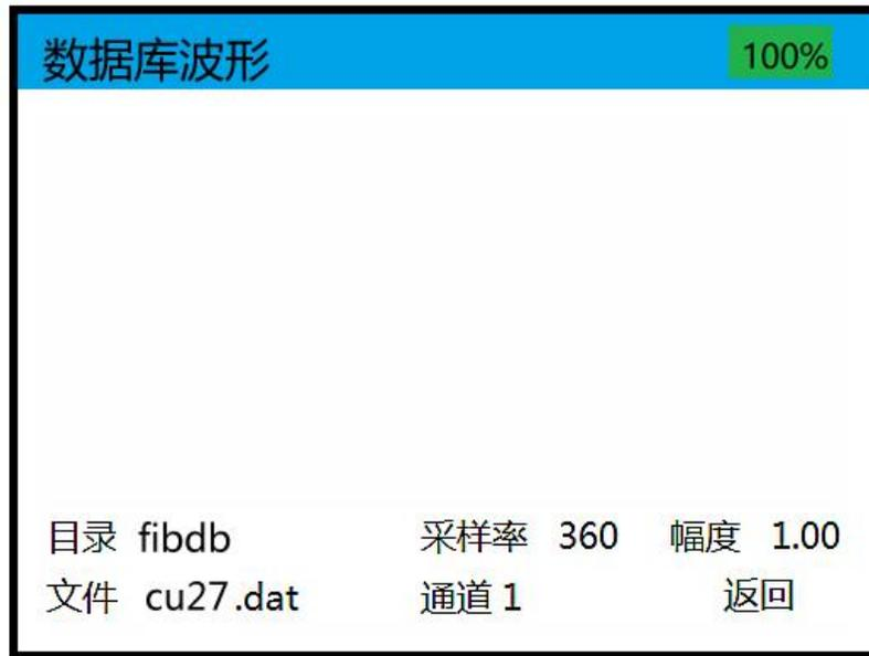
通过此窗口可以选择 U 盘中存放的多个数据库内容的波形文件，进行波形输出，可以输出 nstdb, mitbih, ahadb, cudb, sventdb, fibdb, ventdb, Pvc Mdb, Define, ANSIAAMI 文件中的波形；
