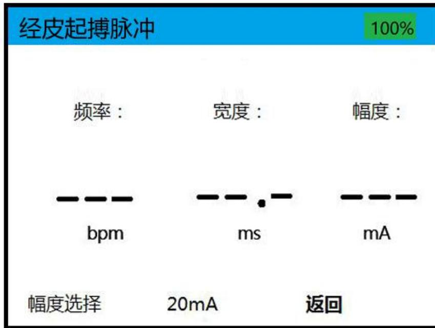
**幅度选择：**根据除颤器的脉冲幅度，请选择合适的检测范围，当检测脉冲幅度范围不大于 20mA 时，请选择幅度为 20mA，当检测脉冲幅度范围大于 20mA 时，请选择 200mA，否则脉冲幅度将超过检测范围或者数值过低引入较大误差。
