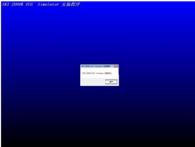
7、到 windows 的“开始” - “程序”中查找如下图中的软件文件，选择 SKX-2000K，运行程序。（注意，请在运行程序前先连接 USB 串口到计算机，并连接另一端到 SKX-2000K 仪器的通信口，否则会出现错误提示。）
